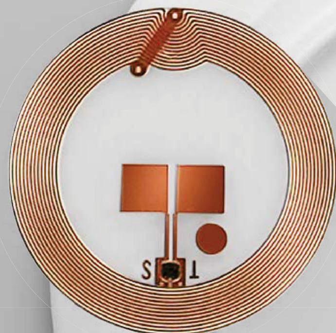
Der versiegelte Transponder ist unempfindlich gegen Feuchtigkeit, Temperaturen bis 85°C, Vibrationen und Schmutz.
